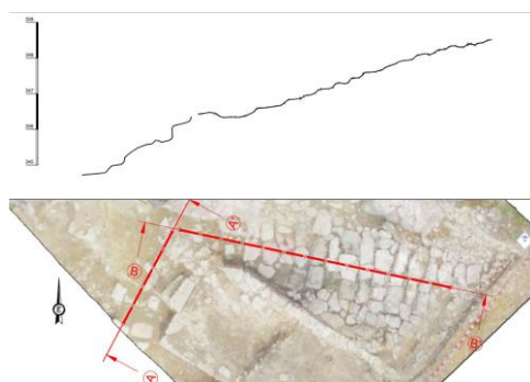
6.ábra Saját fejlesztésű metszetszerkesztő program futási eredménye a Csókakői vár területén feltárt középkori lépcső példáján [7]
